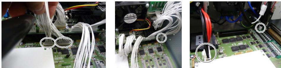
RC700-A: 在DMB上安装12个连接器。
