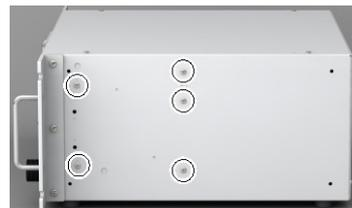
(9) 安装 DMB-OPTION 电路板。
