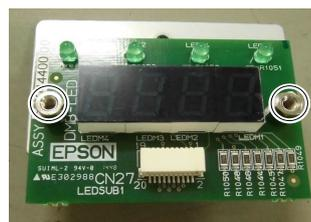
DMB-LED板的安装
